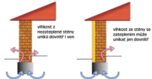
Nevhodné zateplení spodní části zdi izolantem s vysokým difúzním odporem. © EkoWATT
