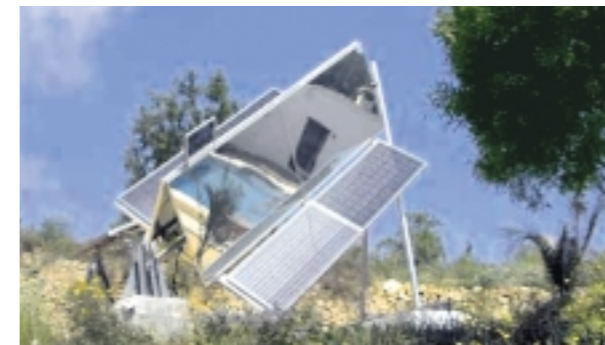
Systém s plochým zrcadlem a jednoosým natáčením systémem TRAXLE. Foto: Steve Jasper
