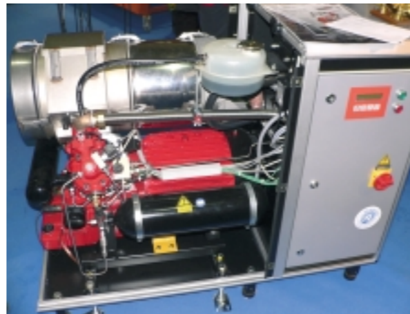
Prototyp malé plynové kogenerační jednotky se Stirlingovým motorem. Foto: EkoWATT
