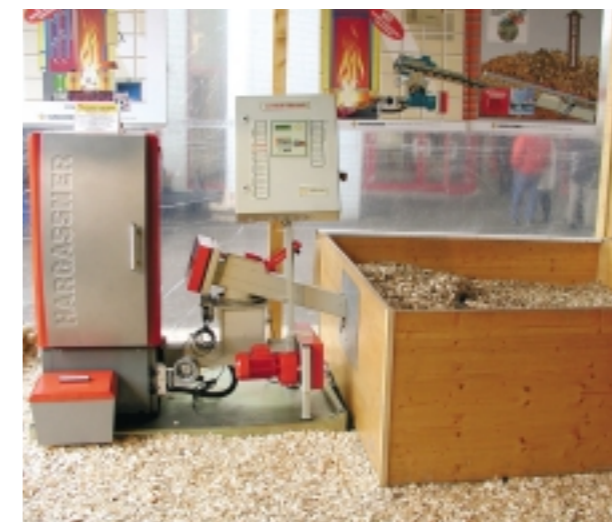
Automatický kotel na štěpku. Foto: EkoWATT
